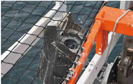
Abb. 7: Hochgeschwindigkeitskamera am Helikopterlandedeck
